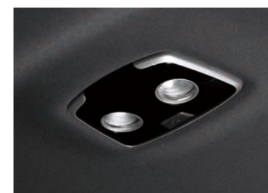
LED osvětlení interiéru
